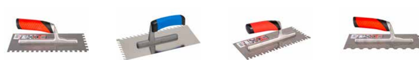
Obr. 10 – Hladítko s kolmým zubem, se šikmým zubem, s K zubem a s půlkulatým zubem
